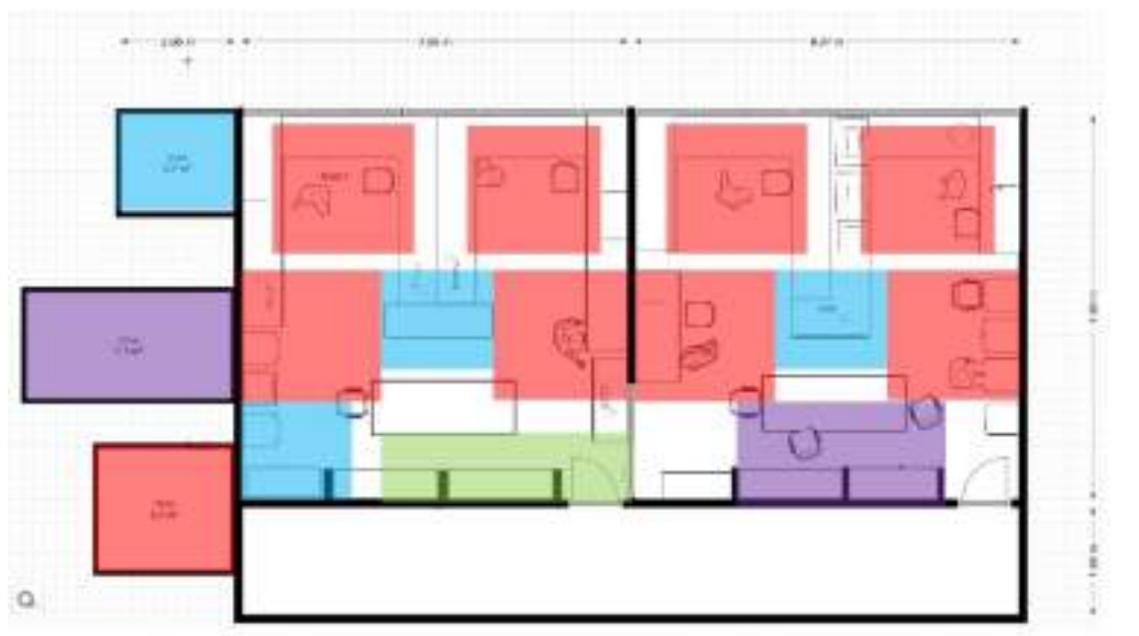
Ilustración 2. Ejemplificación de las áreas de trabajo distribuidas al interior del laboratorio. Cada área roja representa un área de trabajo de 5m 2 designadas para trabajo en equipos específicos. las áreas azules equivalen a 3m 2 y son designadas para tareas transitorias como el lavado y organización de material. El área verde corresponde al área de llegada y salida del laboratorio donde se encontrarán los implementos de bioseguridad y de almacenamiento de bolsos.
